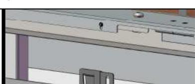
Platziere die Schiene und verschraube durch die Löcher
