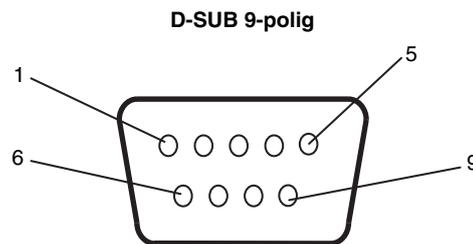
Dieser LCD-Monitor verwendet RXD-, TXD- und GND-Leitungen für die RS-232C-Steuerung.
