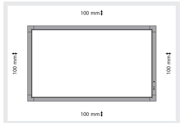
Achten Sie auf ausreichende Luftzufuhr oder sorgen Sie für Klimatisierung am Monitor und an der Montagevorrichtung, damit die entstehende Wärme abgeführt werden kann, insbesondere, wenn Sie mehrere Monitore nebeneinander verwenden.
