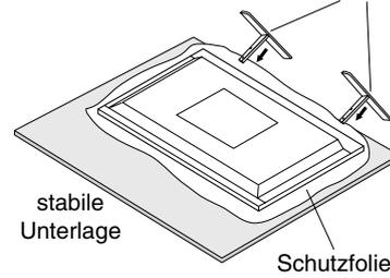
**HINWEIS:** Montieren Sie den Fuß in Richtung der auf der Oberfläche des Fußes eingepprägten Pfeilmarkierung. Verwenden Sie das Modell ST-651.
