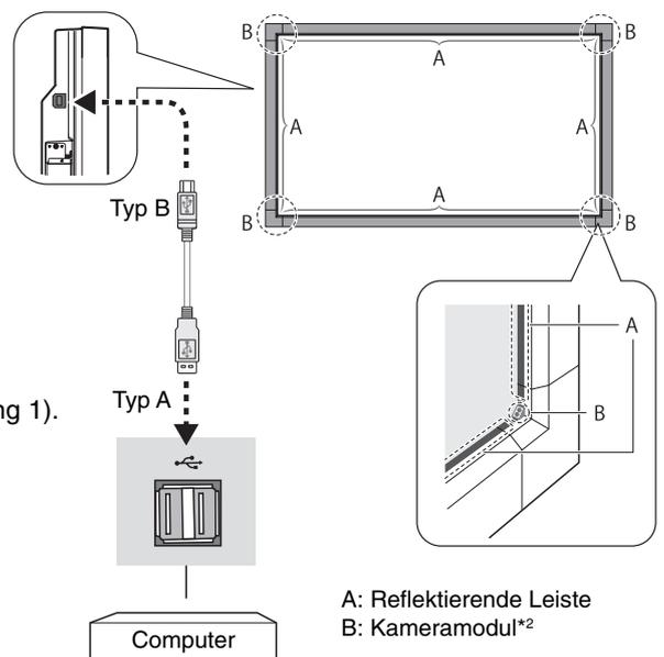
\*2 Das Kameramodul besteht aus einer Infrarotlichtquelle und einem Sensor.
